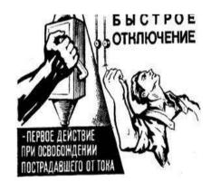
вывертывания *предохранителей* (пробок), *разъема* штепсельного соединения. Если отключить установку достаточно быстро нельзя, необходимо принять меры к освобождению пострадавшего от электрического тока.
