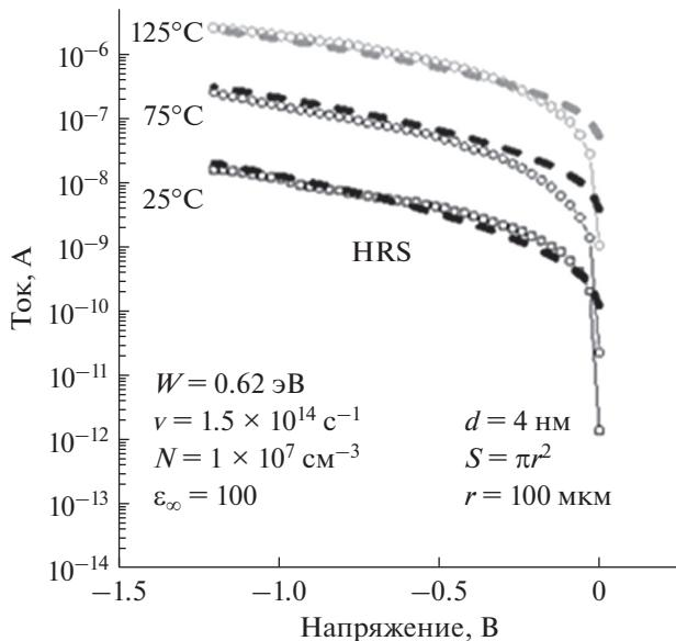
Рис. 5. Вольтамперные характеристики структуры ReRAM Ni/Si<sub>3</sub>N<sub>4</sub>/SiO<sub>2</sub>/p+ - Si в состоянии HRS и кривые моделирования на основе модели Френкеля.
