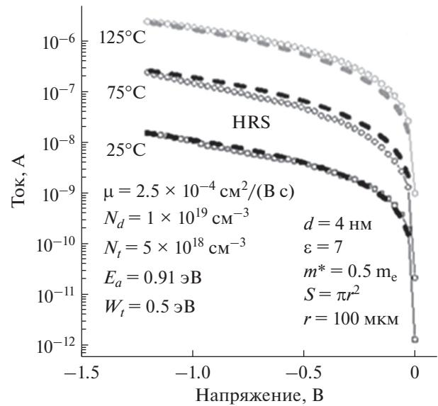
Рис. 6. Вольтамперные характеристики структуры ReRAM Ni/Si<sub>3</sub>N<sub>4</sub>/SiO<sub>2</sub>/p+ - Si в состоянии HRS и кривые моделирования на основе модели SCLC.
