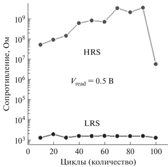
Рис. 2. Циклирование в МНОП мемристоре при комнатной температуре. Длительность импульса = 50 мс,  $V_{\text{set}} = 4.5$  В,  $V_{\text{reset}} = -3.5$  В,  $V_{\text{read}} = 0.5$  В.
