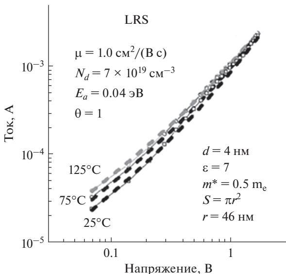
**Рис. 7.** Вольтамперные характеристики структуры ReRAM Ni/Si<sub>3</sub>N<sub>4</sub>/SiO<sub>2</sub>/p<sup>+</sup>–Si в состоянии LRS и кривые моделирования на основе модели SCLC.
