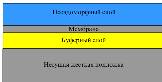
Рис. 17. Схема эпитаксиального роста на "податливой" подложке, включающей вязкостную прослойку на основе SiO 2 или борофосфоросиликатного стекла.
